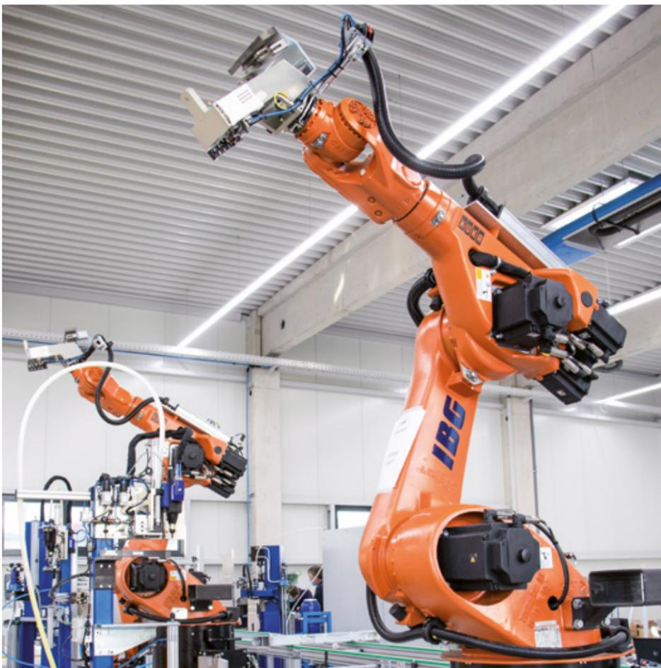
Zum automatisierten Bearbeiten von Bauteilen haben wir für einen Kunden eine automatische Montageanlage konzipiert. Die Bauteile für die Automobilindustrie durchlaufen in dieser Anlage verschiedene Press- und Nietstationen. Die Aluminiumprofile werden durch einen Mitarbeiter auf ein Fördersystem abgelegt und den einzelnen Bearbeitungsstationen automatisch zugeführt. Nach Durchlaufen der Montageanlage wird das fertige Bauteil in Transportbehältern abgelegt.
