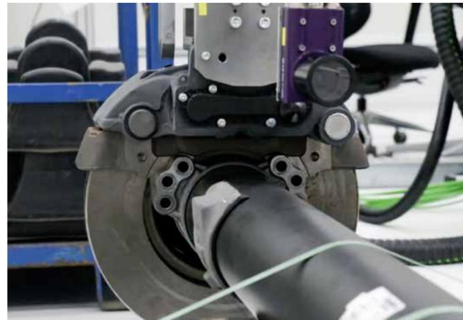
Durch die Kombination eines Industrieroboters mit speziellem Greifsystem und einer geeigneten Visionstechnologie konnte die Handhabung und Montage von Bremssätteln an LKW-Aufliegerachsen umgesetzt werden. Nach Ausrichtung der Achse entnehmen zwei Roboter die zu montierenden Bremssättel, positionieren sie entsprechend der Anschraubpunkte und verschrauben mit dem geforderten Drehmoment verschraubt. Anschließend wird die Achse an die nächste Station übergeben.
