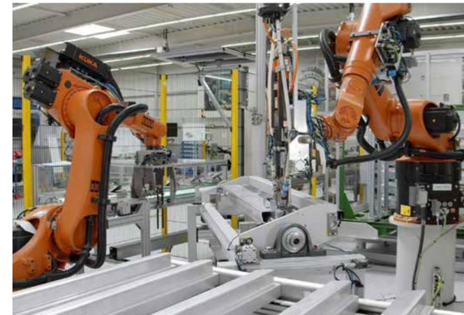
In dieser Anlage wird ein Einleger für einen Innenschweller eines Elektrofahrzeugs hergestellt und verpackt. Die Ausführung als flexible Roboterzelle mit zwei Robotern ermöglicht sehr niedrige Rüstzeiten. Über einen Werkstückträger werden die Winkel zugeführt und mit Visionstechnik überprüft. Die Dichtmasse wird durch den Roboter in einer jeweiligen optimierten Bahn aufgebracht. Die Verschraubungen werden unter Überwachung von Drehwinkel und Drehmoment ausgeführt.
