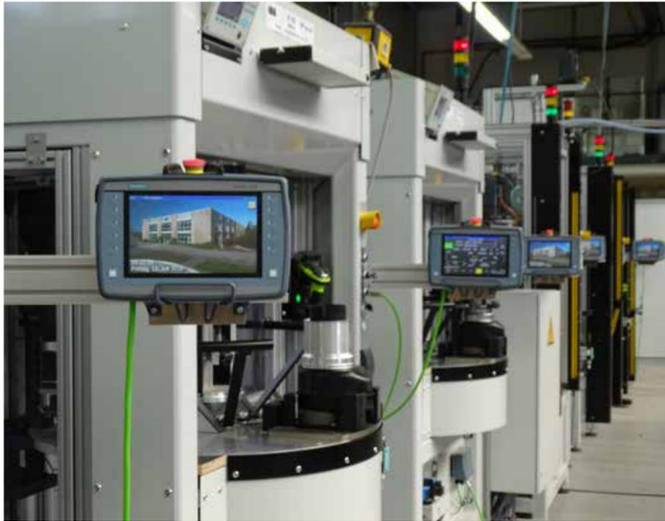
Als innovatives Unternehmen im Bereich der Automatisierungstechnik rundet IBG sein Portfolio mit halbautomatisierten Anlagen ab. Entsprechend der Anforderung erhält unser Kunde ein Anlagenkonzept, welches aus hochflexiblen Einzelzellen besteht. Diese sind jeweils mit eigenen autarken Steuerungen ausgestattet. Dabei erfolgen die Bauteileingabe und der Bauteiltransport von Station zu Station durch das Bedienpersonal, während sämtliche Montage- und Prüfaufgaben automatisiert durchgeführt werden.
