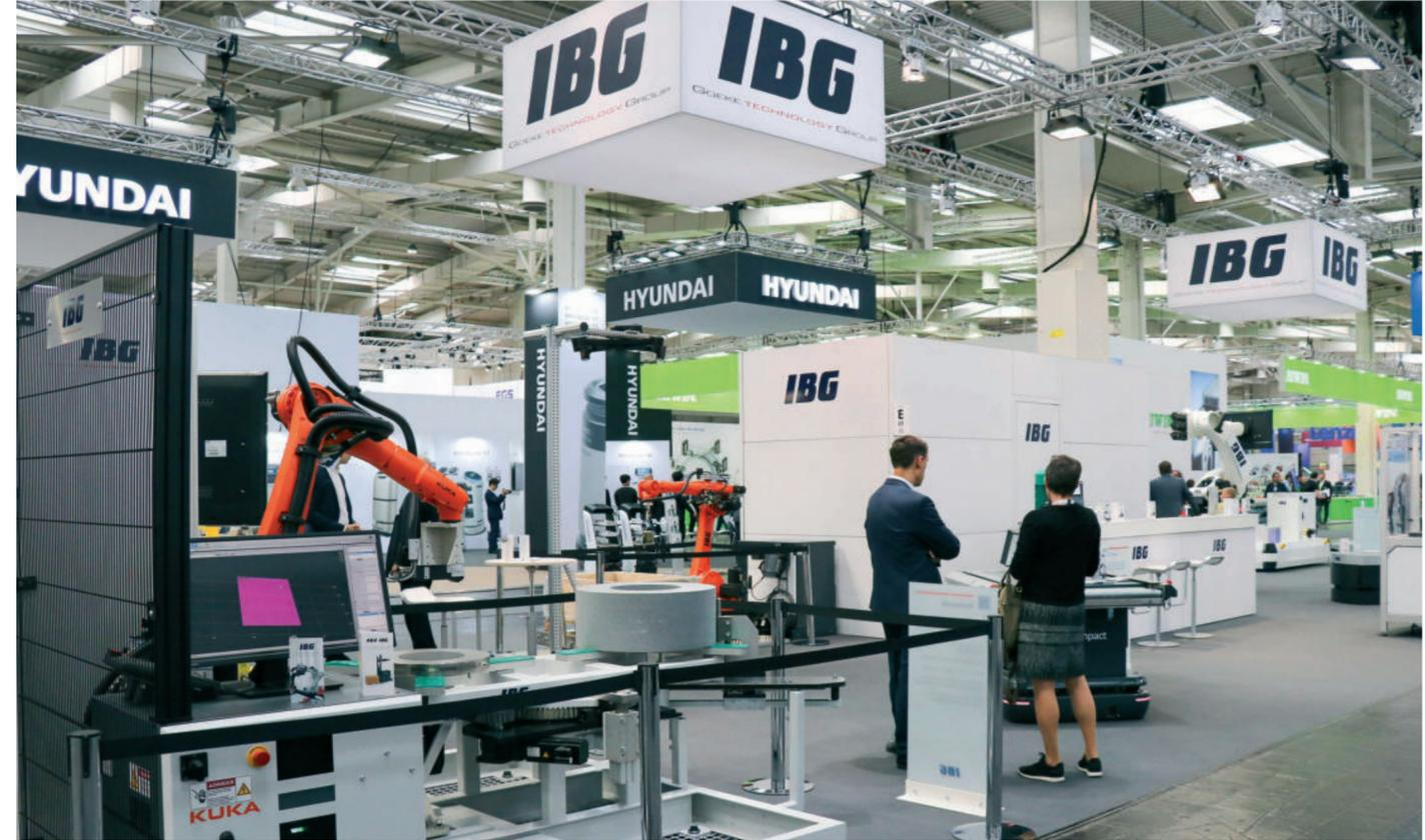
Visionstechnik: Optischer Prüfplatz für verschiedene Bauteilbeschaffenheiten (Vordergrund) und Bin Picking für ein prozesssicheres Greifen (Hintergrund) | Vision technology: Optical inspection station for various component properties (foreground) and bin picking for process-safe gripping (background)
