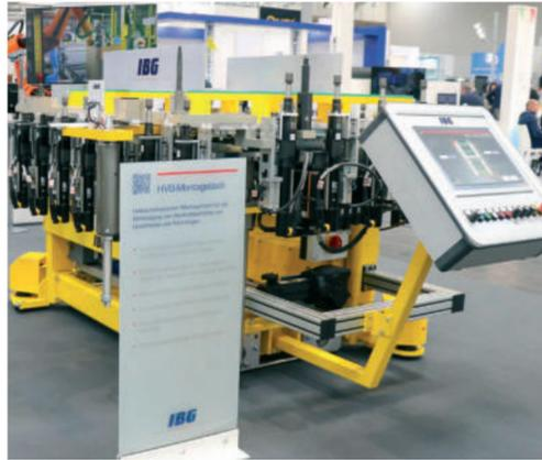
Halbautomatischer Montageetisch für die Befestigung von Hochvoltbatterien am Unterboden von Fahrzeugen | Semi-automatic assembly table for mounting high-voltage batteries on the underbody of vehicles
