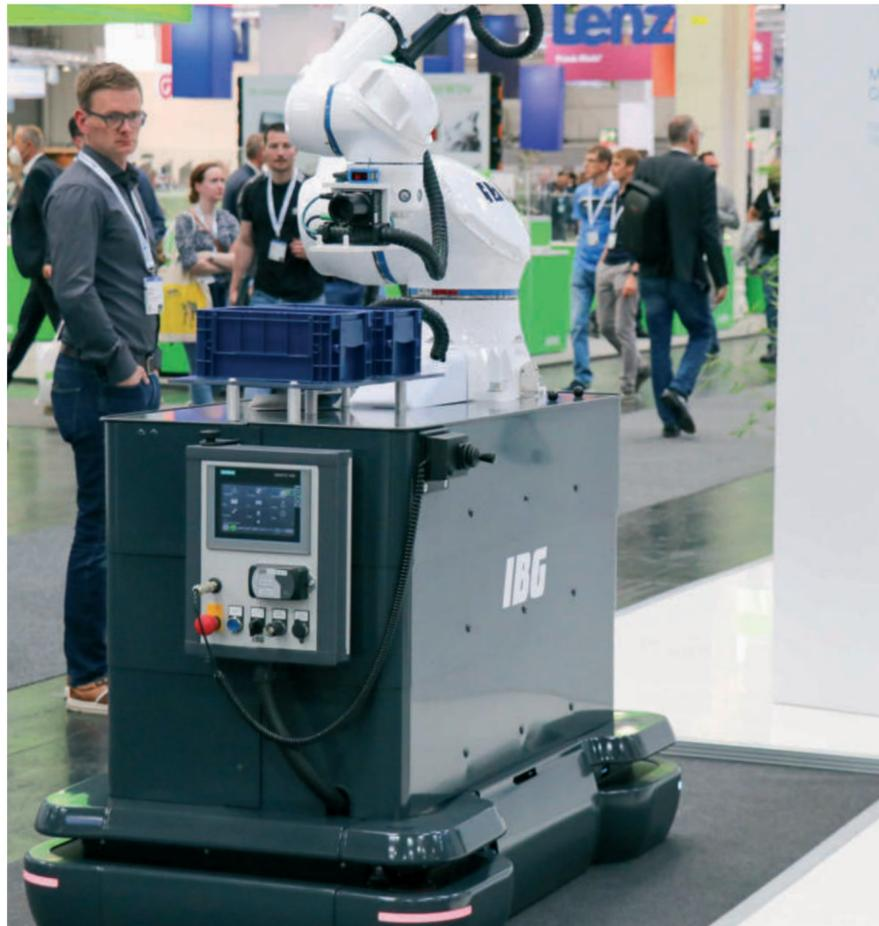
FC RobotLite – echte Mobile Robotik bestehend aus unserem bewährtem FC Compact und dem kollaborativen Roboter Yaskawa HC20 | FC RobotLite - true mobile robotics consisting of our proven FC Compact and the Yaskawa HC20 collaborative robot
