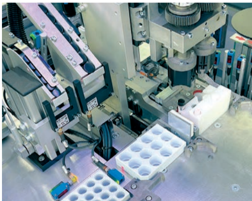
Greiftechnik: In einer vollautomatischen Roboterzelle werden unterschiedliche Varianten von Ampullen im Labor gescannt, gegriffen, entdeckt, gewogen und anschließend wieder verschlossen. Über ein HMI stehen dem Werker verschiedene Programme zur Verfügung. Dementsprechend werden die Deckel von einer elektromotorischen Schraubeinheit mit Drehmomentüberwachung gelöst oder aufgeschraubt. Die Ampullen werden nach der Abarbeitung wahlweise in dieselben oder andere Ladungsträger zurückgesetzt.
