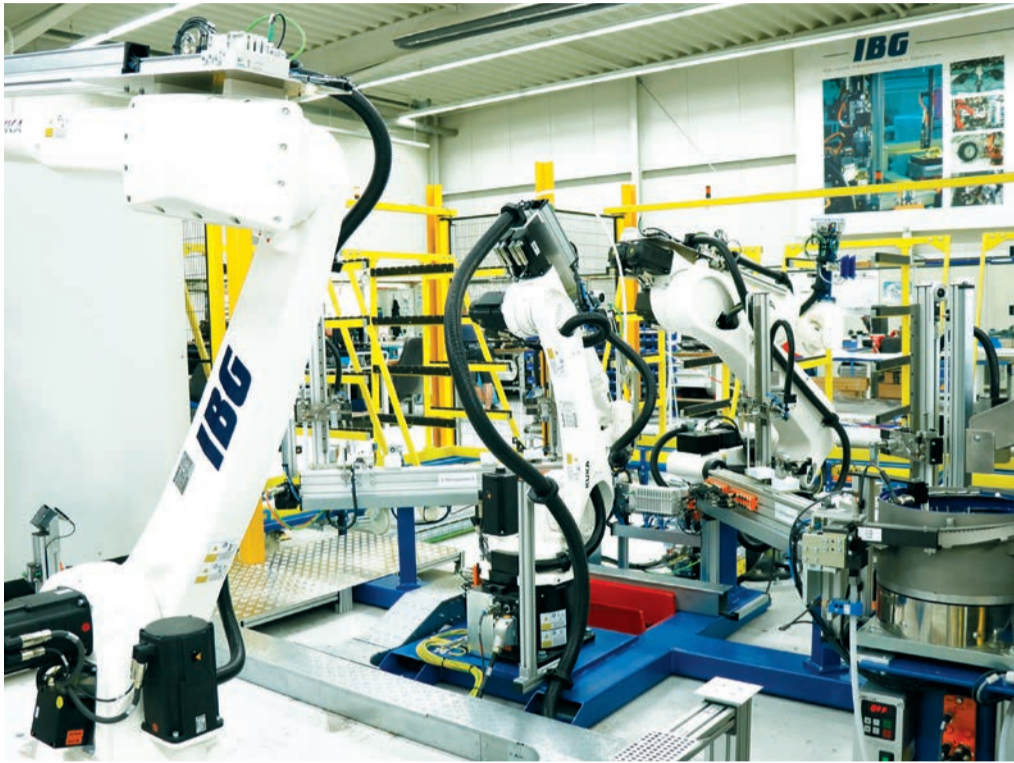
Montagesystem: Für die automatische Montage eines Handlaufs auf Seitenteile von Krankenhausbetten haben wir eine 3-modulige Montagezelle (Zuführung, Montage- und Auszugsstation) entwickelt, die mehrere Transportbehälter vollautomatisch nacheinander montiert.
