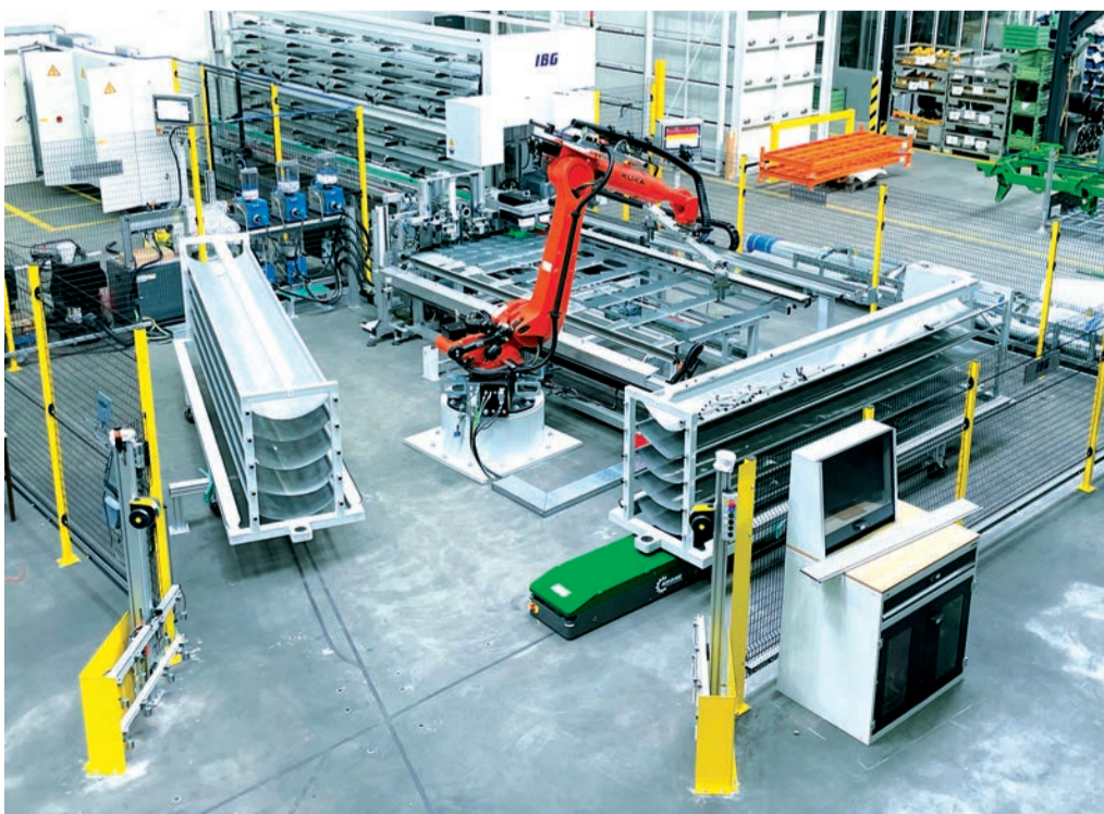
Sonderanlage: Die Anlage konfektioniert Präzisionsstahlrohre mit einer Rohmateriallänge von 6.000 mm und einem Durchmesser von 6-28 mm in auftragsbezogene Zuschnitte von 120-4.000 mm. Für eine eindeutige Rückverfolgbarkeit werden die Zuschnitte laserbeschriftet, beidseitig innen wie außen entgratet und mittels Projektilen gereinigt. Ein automatischer Wechsel der Bereitstellungswagen und die Verkettung mit den Biegemaschinen erfolgt durch unser FTS „FC 450“.
