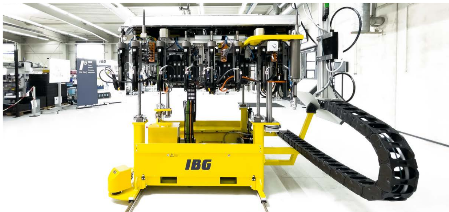
Durch eine automatische Positionierung der Batterie in mehreren Stufen ermöglicht der Montagetisch eine optimalen Ausrichtung der HVB zum Fahrzeug. By automatically positioning the battery in several stages, the mounting table enables an optimum alignment of the HVB to the vehicle.
