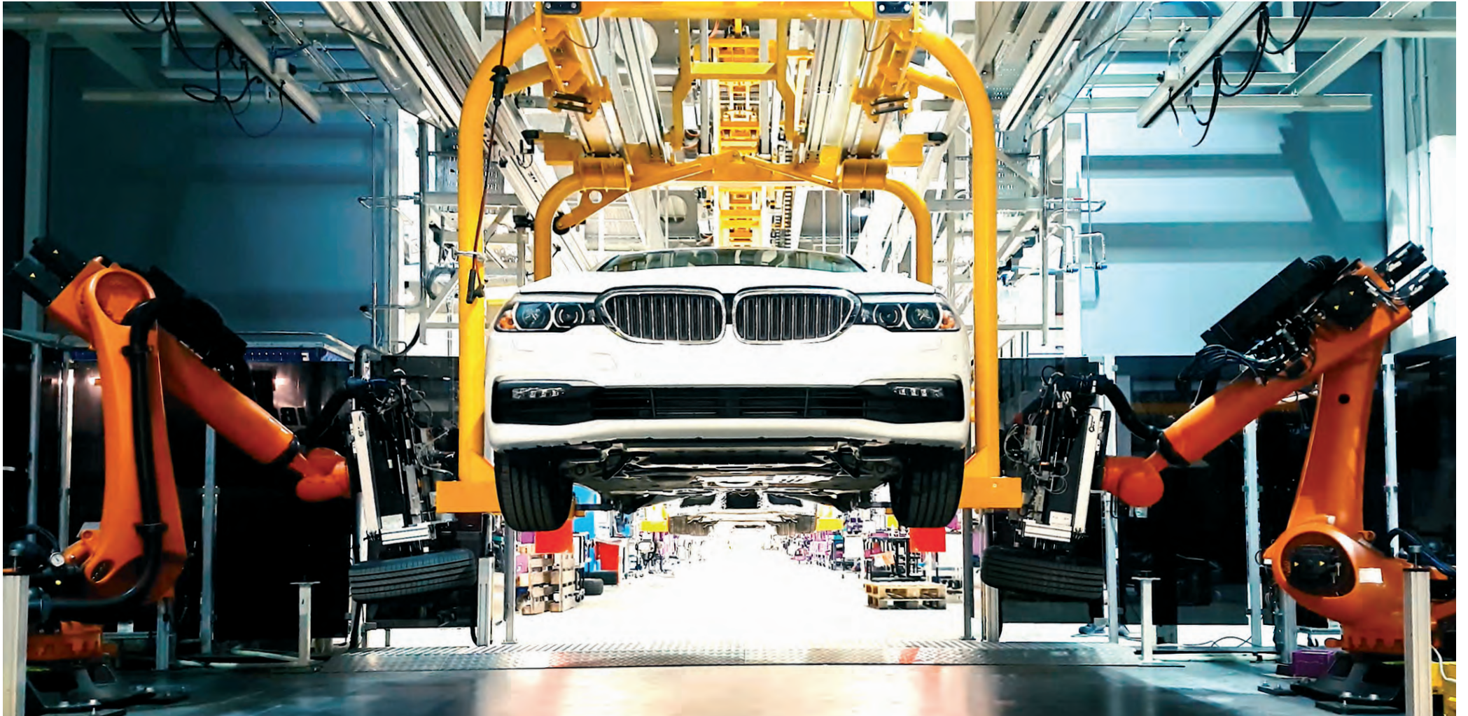
Radmontage: vollautomatische Verschraubung und Montage von Kompletträdern im Fließbetrieb. Wheel assembly: fully automatic bolting and assembly of complete wheels in flow operation.
