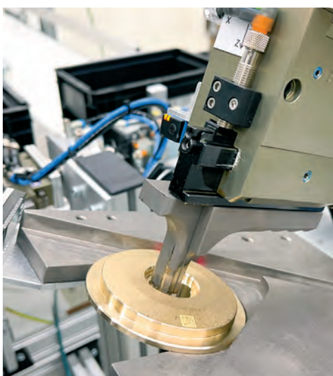
Großes Bild: Bin-Picking zur Entnahme der Einzelbauteile. Kleines Bild: Gegriffenes Bauteil in Zentrierstation. Large Picture: Bin picking to remove the individual components. Small picture: Gripped component in the centring station.
